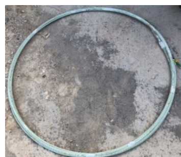
(b) 内嵌光纤自感知 FRP 筋
